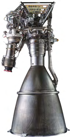
韩国型运载火箭NURI号(KSLV-2)75吨级单级液体火箭发动机
