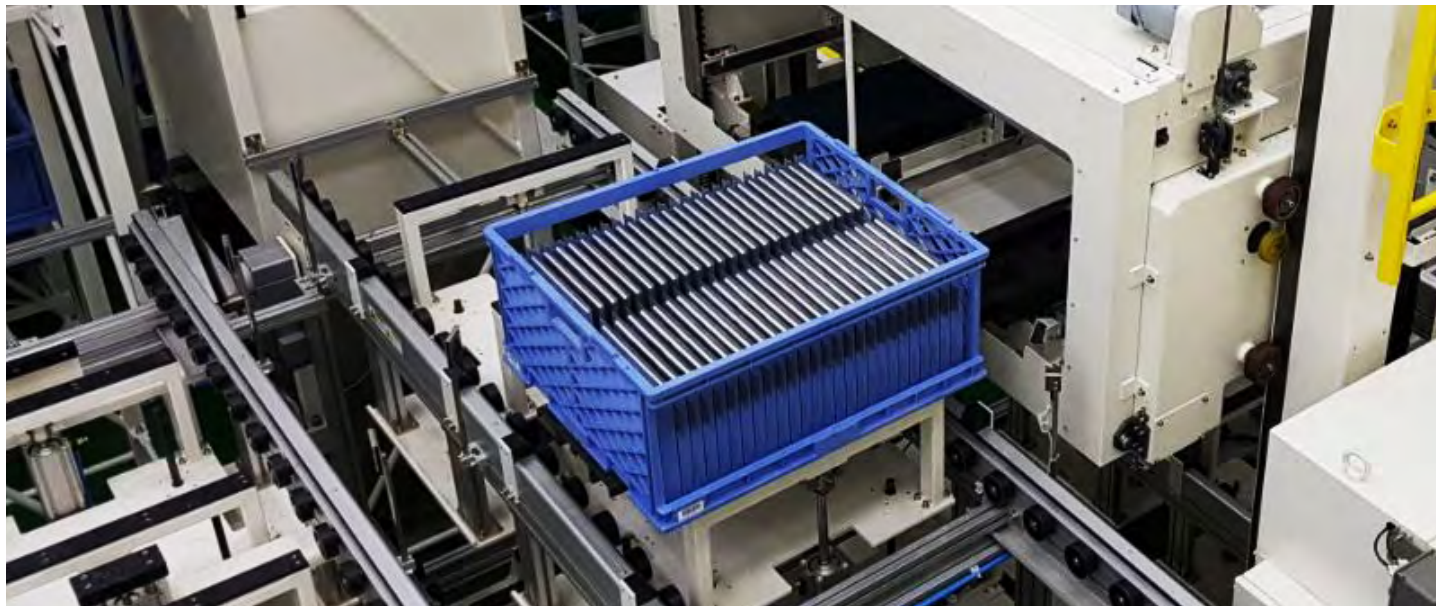
二次电池激活工艺的主要设备码垛机(SC-FSH)
